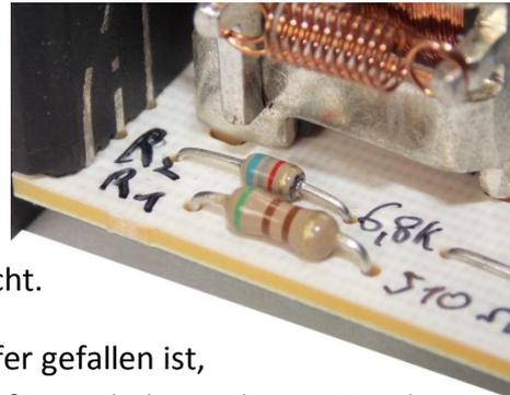
Nach dem also der wehrlose  $R_2$  unserem Umbau zum Opfer gefallen ist, muss zuerst ein Vorwiderstand her. Da ich keine  $2,7k\Omega$  auf Lager habe, ist kurzer Hand ein Exemplar mit  $4,7k\Omega$  von mir verbaut worden. Damit ist die minimale Wischpause von vier auf etwa fünf Sekunden angehoben - sei's drum! Zur Not hätte der  $6,8k\Omega$ -Kollege auch drin bleiben können.
